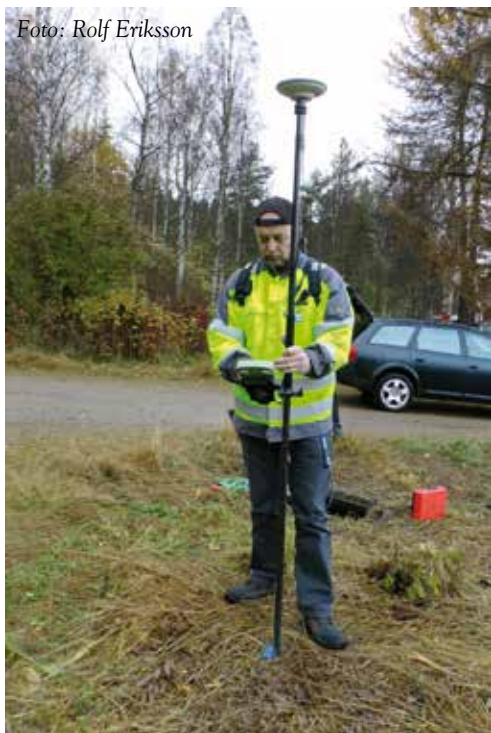
Bredband är en viktig faktor för tillgänglighet. Här mäts fibernätets läge in med hjälp av GPS.
