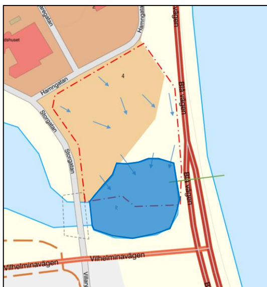
Figur 3-5. Befintlig avrinning inom planområdet. Vattnets rinnvägar är utmarkerade med blåa pilar, plangräns ungefärligt markerat med rött och befintlig trumma under E 12/ Blå vägen ungefärligt placerad och utmarkerad med grönt streck. Den befintliga dagvattendammen är markerat med mörkare blå yta.
